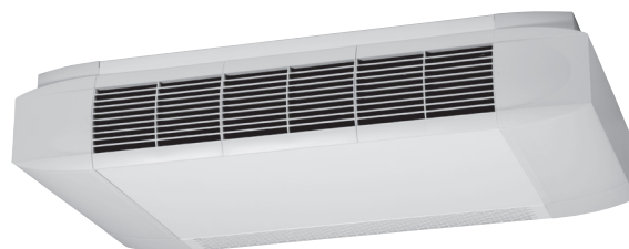
4. ábra HB - vízszintes elülső szívó- és első szűrő eltávolítással, állítható rácsok
