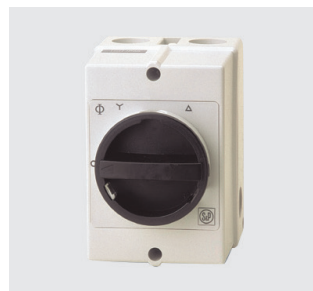
COM D/S 3-állású csillag-delta kapcsoló 400 V, 3-fázisú ventilátorokhoz. (Ki / Csillag / Delta) Max. 20 A, IP67 védelem
